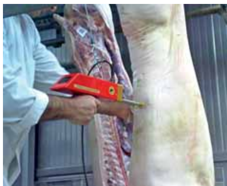
Foto 14. Utvrđivanje udjela mišića u trupu metodom “jedne točke”
